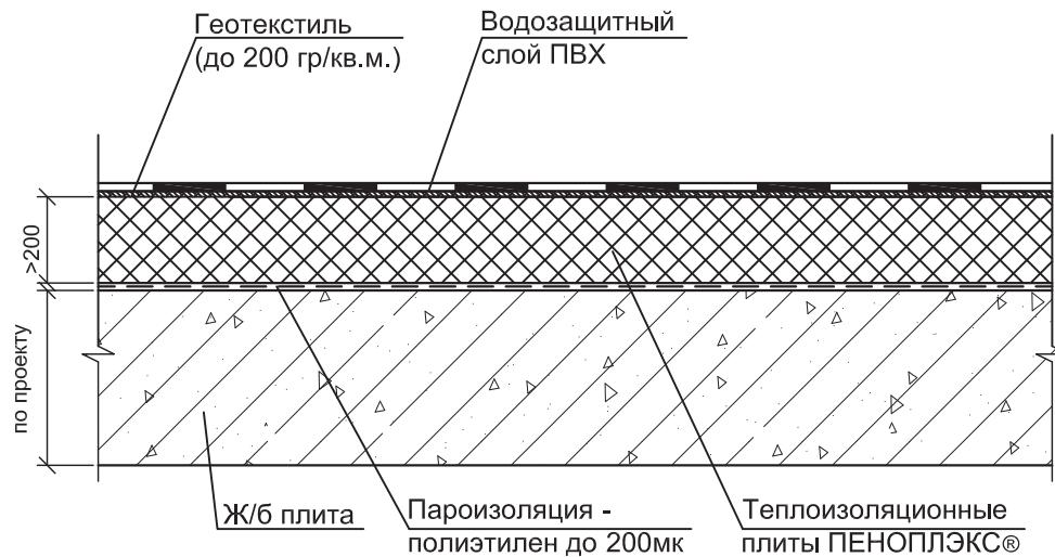
4. Кровля по ж/б основанию, тип 5. Противопожарные характеристики: К0, RE 90
