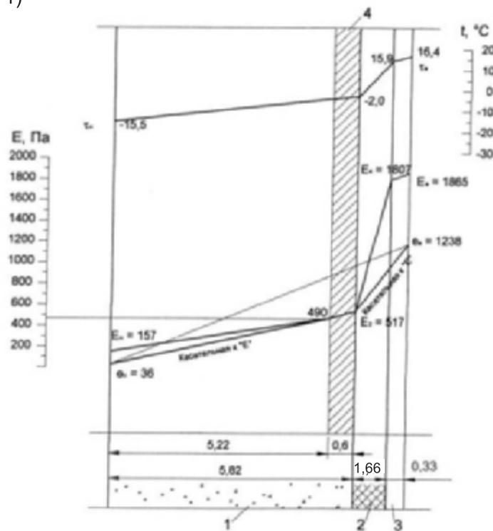
**Рис. 1 Зона конденсации влаги в стене подвала,
