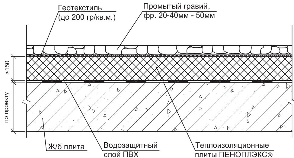
6. Кровля по ж/б основанию, тип 6. Противопожарные характеристики: К0, RE 90
