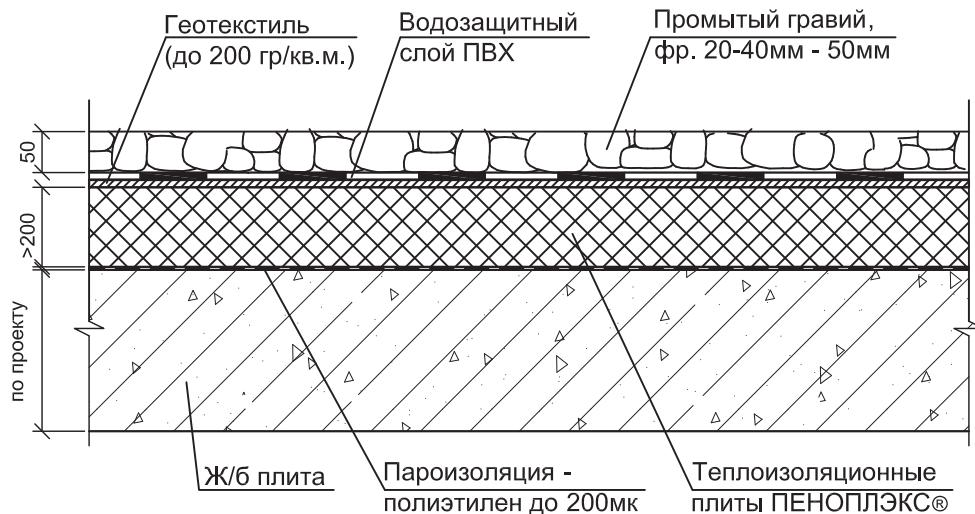
2. Кровля по ж/б основанию, тип 4. Противопожарные характеристики: К0, RE 90
