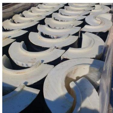
Теплоизоляция "ТИС"® для трубопроводов Скорлупа ППУ- - это полуцилиндры из жесткого пенополиуретана для утепления труб любого диаметра стандартных и нестандартных размеров с
