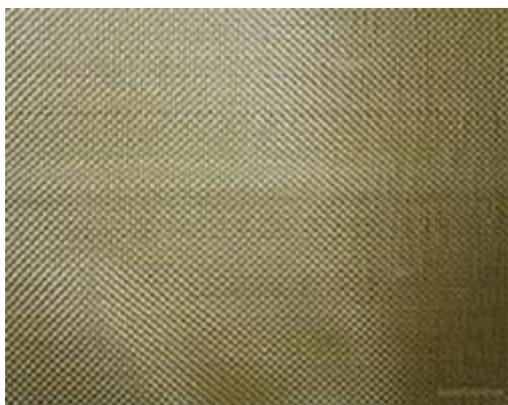
Стеклопластик рулонный марки РСТ представляет собой гибкий рулонный материал, изготовленный на основе стеклотканей с массой на единицу площади от 120 до 1000 г/м<sup>2</sup>, пропитанных полимерным связующим с добавками.
