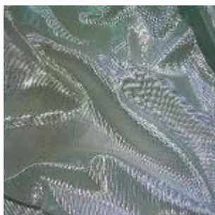
Конструкционные стеклоткани Т-13, Т-23 вырабатываются из нитей алюмоборосиликатного стекла на замасливателе «парафиновая эмульсия» и прямом замасливателе.
