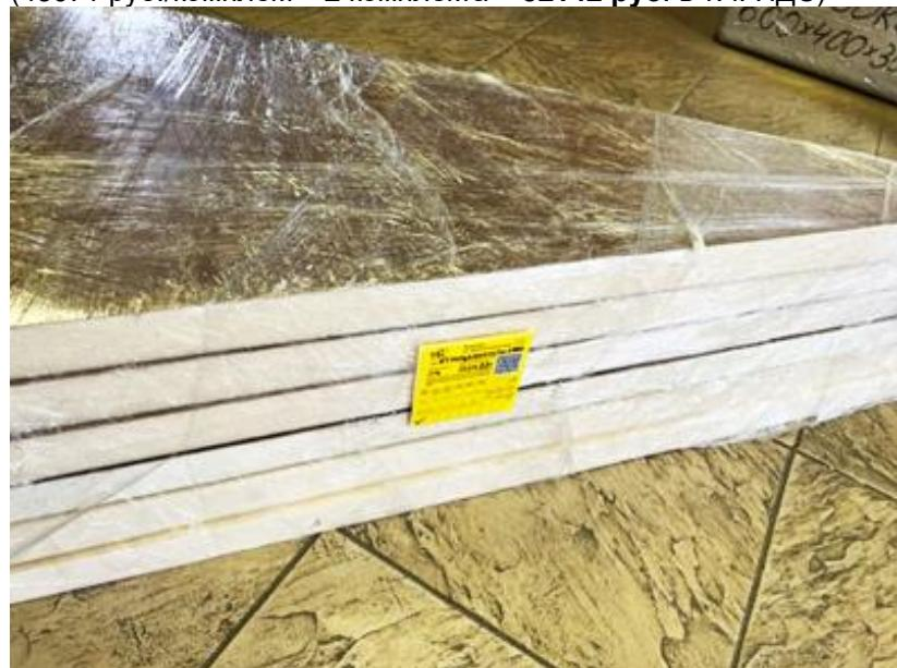
Комплекты теплоизоляции торцов для емкостей ППУ ТИС70 – это особо прочные теплоизоляционные сегменты из жесткого пенополиуретана, плотностью от 50 до 70 кг/м<sup>3</sup>, которые имеют покровный слой из технической бумаги, битумированной бумаги, стеклопластика, фольги или оцинковки. Стандартные комплекты для теплоизоляции торцов емкостей производятся с покровным слоем из битумированной или технической бумаги.
