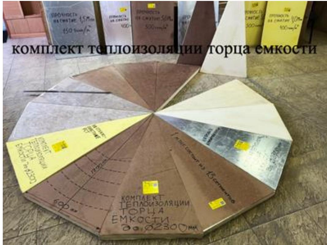
Для ёмкости диаметром от 2400 мм. до 3900 мм., применяются «**Комплекты теплоизоляции торцов емкости диаметром от 2400 мм. до 3900 мм.**», состоящие из 13 треугольных сегментов. Размер одного треугольного сегмента: высота 2000 мм., основание 1000мм.. (длина подрезается по месту), толщина 100 мм..
