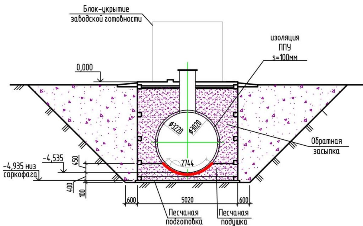
На нижний слой теплоизоляционной конструкции теплоизоляции емкости будет приходиться большая нагрузка. Вес пустого аппарата (пустой емкости) 13100 кг, вес аппарата при гидроиспытании (емкость наполнена водой) составит 113100 кг. В связи с этим, чтобы исключить деформацию теплоизоляционного слоя под нагрузкой, рекомендуется применять «Комплекты теплоизоляции емкости ППУ ТИС100», которые выдерживают большую прочность на сжатие не менее 60 тонн/кв.м., не менее 0,6 МПа.
