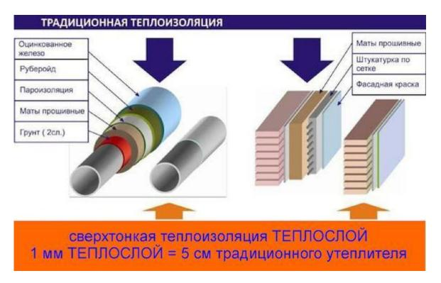
С помощью жидкого теплоизолятора ТЕПЛОСЛОЙ, можно снизить потери теплоносителя до 35%, а значит уменьшить энергозатраты. Так же уменьшается стоимость работ по теплоизоляции, так как материал наносится как обычная краска на водной основе.
