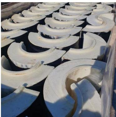
Теплоизоляция "ТИС"® для трубопроводов Скорлупа ППУ- - это полуцилиндры из жесткого пенополиуретана для утепления труб любого диаметра стандартных и нестандартных размеров с продольными и торцевыми замками в четверть. На внешней стороне теплоизоляции для трубопроводов предусмотрен защитно-покровный слой из стеклоткани, фольги и бумаги, пропитанной битумом, оцинковки.
