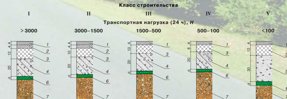
Рис. 3. Размеры слоев асфальтовых дорожных покрытий с теплоизоляцией (см): 1 – покрытие; 2 – связующий слой; 3 – асфальтовый слой; 4 – гидравлически связанный несущий слой гравия; 5 – несвязанный слой гравия; 6 – теплоизоляция Styrodur®С; 7 – основание.
